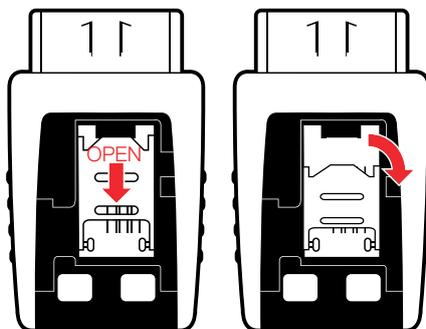
04. Insérez la carte SIM, repositionnez le clapet et verrouillez-le en place.
